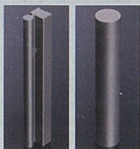
电极丝 \phi 0.2/BS 工件 SKD11/t60mm
